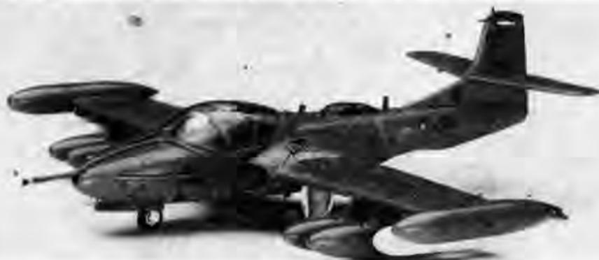
セスナ A-37 ドラゴンフライは、T-37 初級ジェット練習機から発達した対ゲリラ戦用攻撃機、いわゆる COIN 機です。A型は、T-37B より 39 機が作られ、続いてより強力なエンジンと空中受油装置を備えた B 型が生産されました。1980 年にはアメリカ州航空隊が A-37B を前線空中管制 (FAC) 用に採用し、型式名を OA-37B としました。
