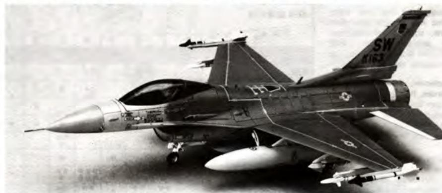
ジェネラル ダイナミックス F-16C ファイティング ファルコンは、MSIP(多段階改良計画)に基づいて、F-16A PLUSから発達した機体です。武装搭載量の増大と電子機器の強化が計られ、AIM-120 (AMRAAM) の多目標同時攻撃が可能になるなど、空戦処理能力が大幅に向かっています。又、前方に延長された垂直尾翼付け根部分は、外見上の大きな特徴となっています。
