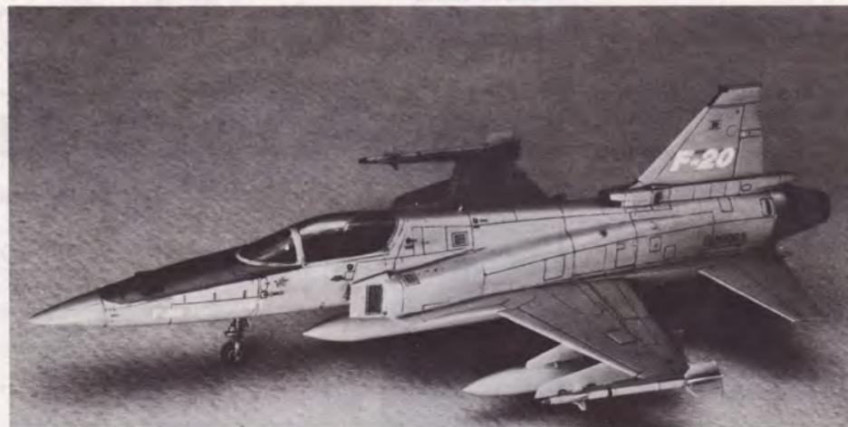
ノースロップF-20タイガーシャークは、ソ連の輸出戦闘機MIG-23/-27に対抗するためにつくられた国際戦闘機で、開発当初はF-5Gと呼ばれていました。エンジンはF-5EのJ81双発からF404単発に代りましたが、推力は60%増えて、速度／加速性能・運動能力は大幅に向上了しました。レーダー火器管制装置もより高性能なAPG67を搭載して、空対空／空対地／格闘戦の戦闘能力向上をはかっています。
