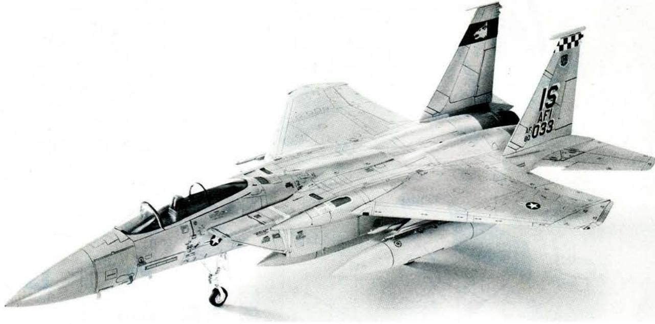
マクドナル・ダグラスF-15Cイーグルは、アメリカ空軍の主力戦闘機です。1969年12月アメリカ軍はF-4ファントムIIの後継機となる次期主力制空戦闘機をマクドナル・ダグラスに決定しました。これを受け製作されたF-15は、F-4ファントムIIよりひとまわり大きな機体にもかかわらず複合材料などの使用により自重はF-4ファントムIIより軽くできています。この機体に強力なエンジンと最新の電子機器を装備して、優れた飛行性能と戦闘能力を誇っています。また1980年5月から生産されているF-15C型は、火器管制装置が改良され、多目的同時捜索、追跡が可能になった他、A.B型で問題があった機内燃料容量が増加されています。また胴体側面にカヌー型のコンフォーマルタンクが装備できるようになっています。
