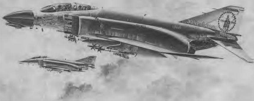
F-4ファントムIIは各型、合せて5,195機生産された、西側陣営の主力戦闘機です。F-4Cは海軍のF-4Bを空軍向けに改造したもので、エンジンは火薬カートリッジ始動が可能なJ79-GE-15を装備し、滑走路を使用するため幅の広いタイヤが装着されています。またC型から対地攻撃力をより向上させた機体がF-4Dです。1988年6月3日～5日までカナダ・オンタリオ州のロンドンで開催されたロンドン・インターナショナル・エアーショーでは、26機のF-4が集結し、初飛行から30周年を祝っての大きなショーとなりました。なかでも906TFG/89TFSのF-4Dは、スペシャルマーキングが施されひときわ目立っていました。
