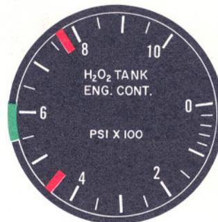
**H<sub>2</sub>O<sub>2</sub> TANK AND ENGINE CONTROL LINE PRESSURE GAGE**
